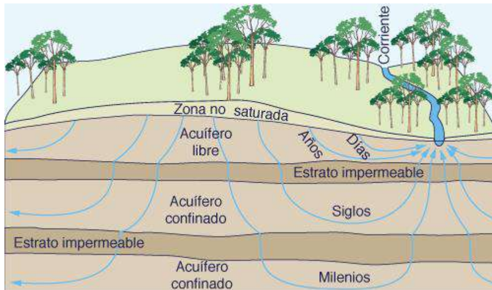
Figura 2.1 Movimiento del agua subterránea en el subsuelo
